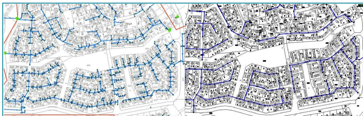
Rys.14. Szkieletyzacja modelu, przykład Pori. Po lewej: cały system, po prawej: rury, które zostały uwzględnione w modelu.
